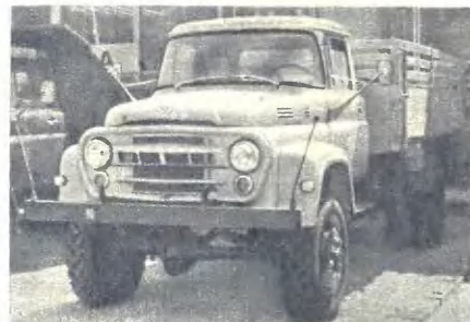
3-тонный автомобиль «Карпачь-СР-132». Это вариант (с обеими ведущими осями) базовой модели СР-131.
